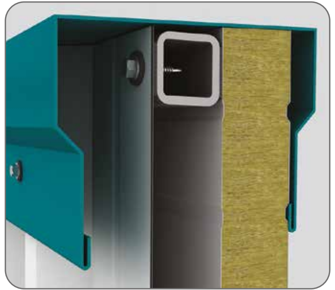
Harpuşta Detayı / Protection Cap Detail
