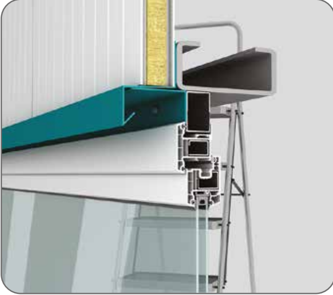
Pencere Üst Detay / Window Upper Detail
