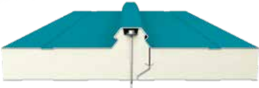
Birleşim Detayı / Connection Detail
