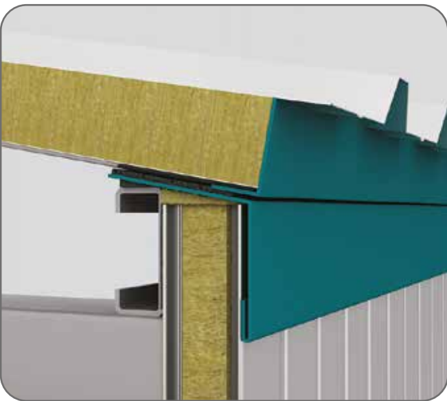
Ön Alın Kaplama Detayı / Front Covering Detail
