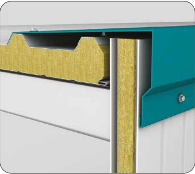
Yan Alın Detayı / Side Front Covering Detail
