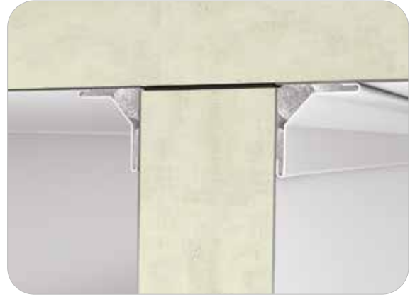
Soğuk Oda Dış Köşe Detayı-2 / Cold Room Outer Corner Detail-2
