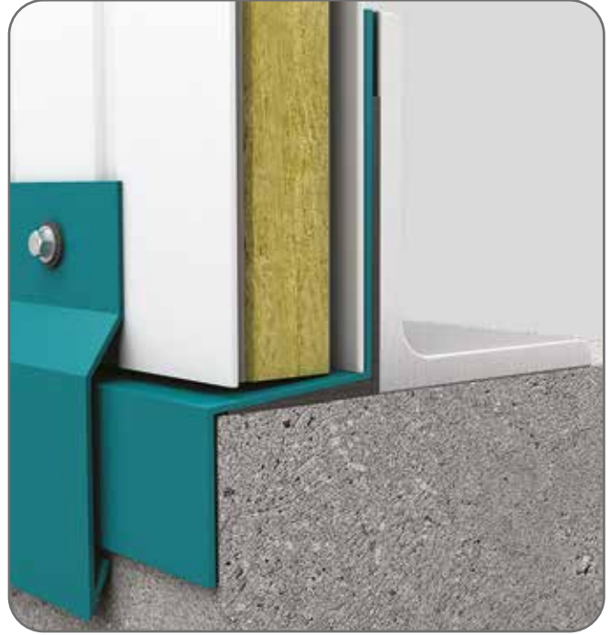
Damlalık Detayı / Drip Box Detail
