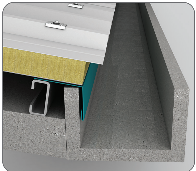
Oluk Betoneme Detayı / Gutter Detail
