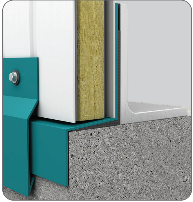
Damlalık Detayı / Drip Box Detail
