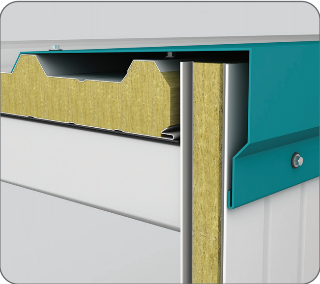
Yan Alın Detayı / Side Front Covering Detail
