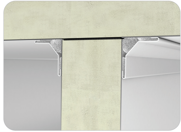
Soğuk Oda Dış Köşe Detayı-2 / Cold Room Outer Corner Detail-2
