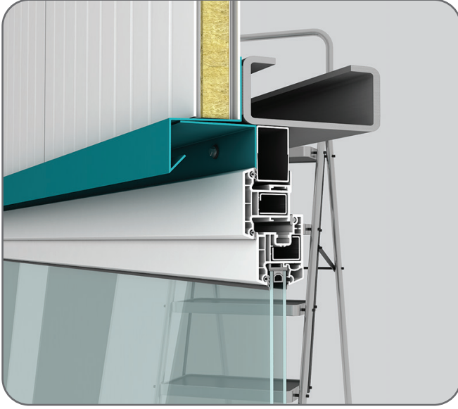
Pencere Üst Detay / Window Upper Detail
