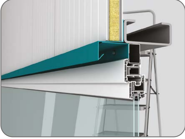
Kalkan Duvar Çatı Birleşimi-1 / Shield Roof-Wall Connection Detail-1
