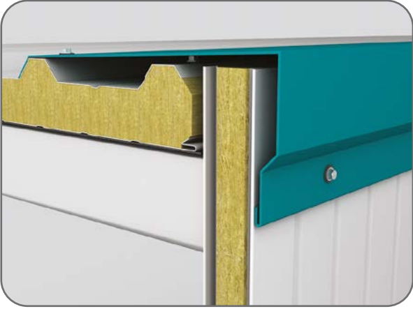
Duvar Çatı Birleşim Detayı / Wall-Roof Connection Detail
