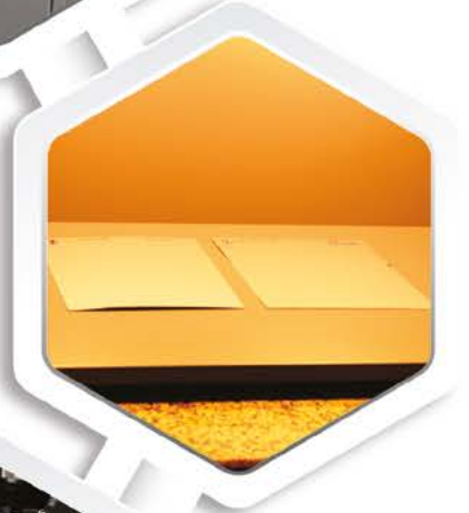
Işık Kabini ile Renk Kontrolü Color Control by Light Cabin
