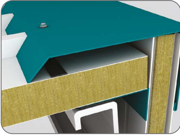
Panel Birleşim Detayı-1 / Panel Connection Detail-1
